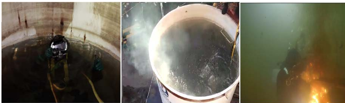
Figura 5: da esquerda para a direita, o mergulhador-soldador dentro do tanque no decorrer do experimento; vista de cima do tanque durante a execução do experimento; vista de dentro do tanque durante uma soldagem subaquática molhada, onde é possível visualizar as partículas de poluição na coluna da água como uma massa escura acima do mergulhador.
