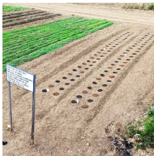
Figura 2. Detalhe do cravamento dos anéis no solo e da disposição do resíduo sobre a superfície do solo.
