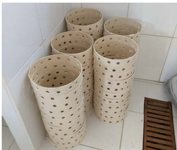
Figura 1. Anéis perfurados utilizados para acondicionar o resíduo do beneficiamento de grãos do café no solo.
