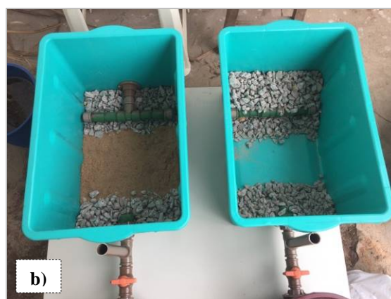
b) Preenchimento do sistema com brita, areia e terra.
