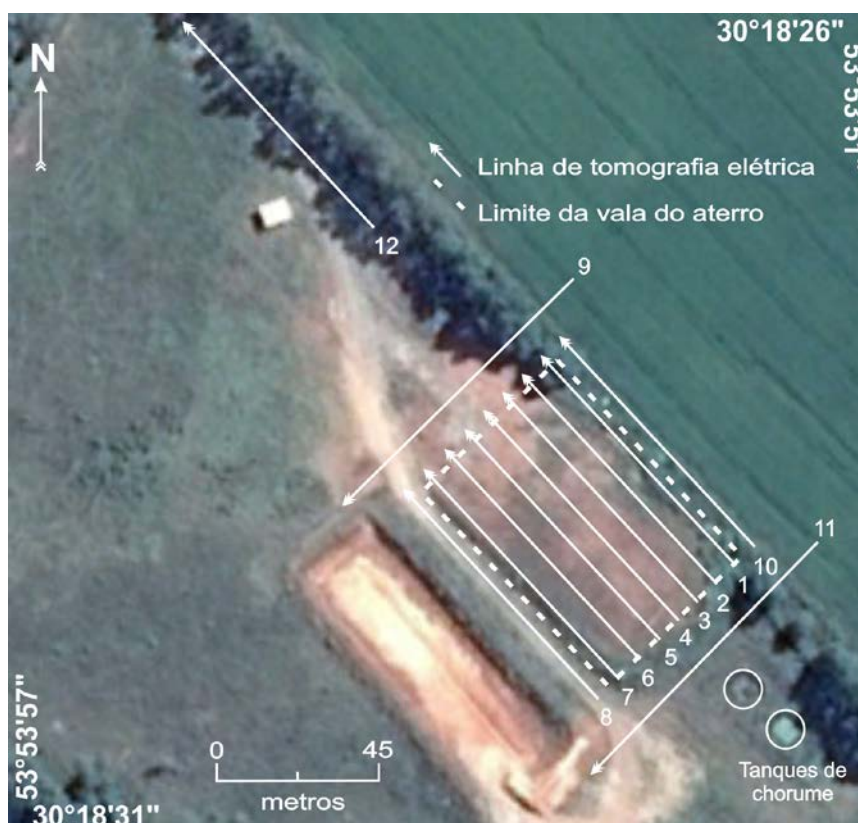
Figura 1 – Disposição das linhas de tomografia elétrica em campo (Fonte: adaptada de Google Earth)
