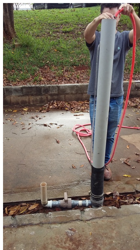
(b) Utilização do permeâmetro, preenchimento com água.
