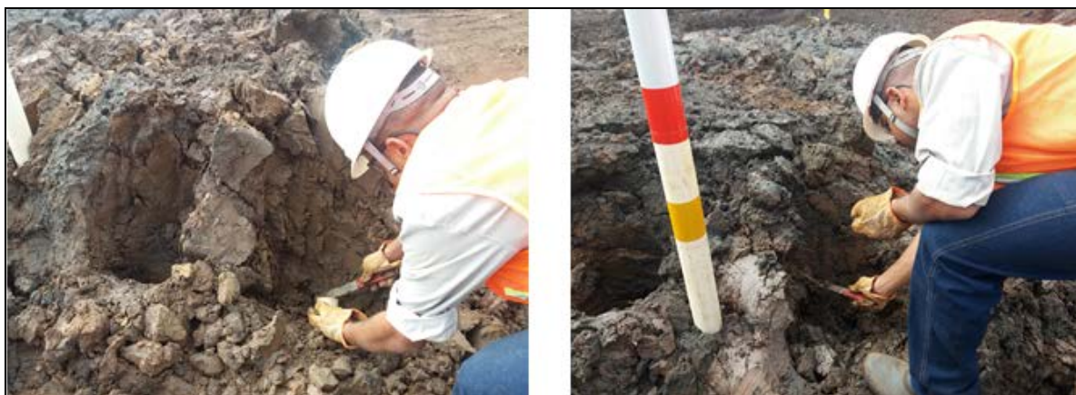
Figura 3: Acompanhamento de coleta para ensaio de umidade.
