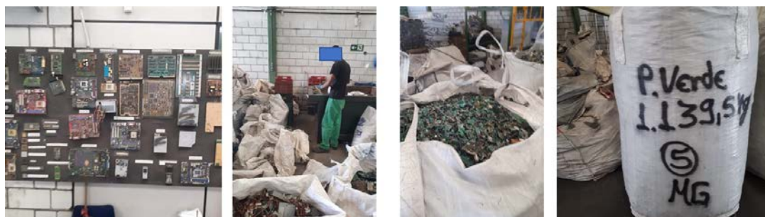
Figura 2: Preparação das placas de circuito impresso pós-consumo para exportação.
