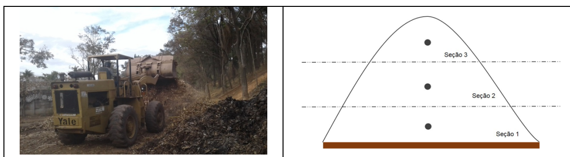
Figura 1: Uso da pá carregadeira na montagem (a), formato e pontos de monitoramento dos parâmetros nas leiras (b), do pátio de compostagem do Pampulha (UFMG).
