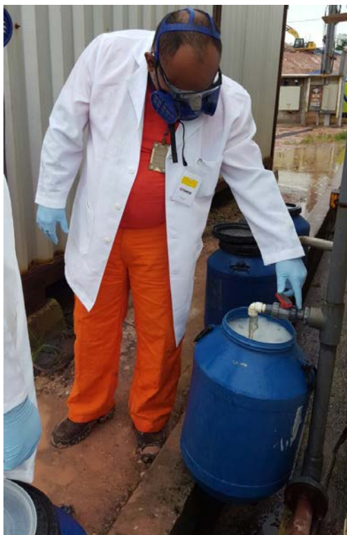
Figura 1: Ilustração da coleta de lixiviado por manobra de válvula em período chuvoso.
