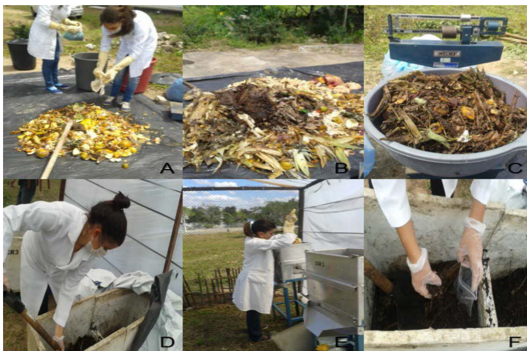
Figura 2: montagem e monitoramento do sistema de compostagem. Legenda A: despejo do resíduos orgânicos. B: homogeneização. C: pesagem. D e E: reviramento do substrato. F: coleta de amostras.
