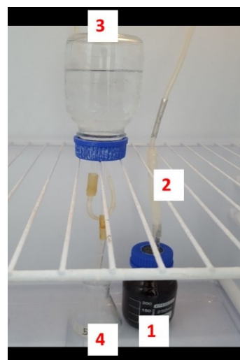
Figura 2 - Aparato experimental para o teste BMP
