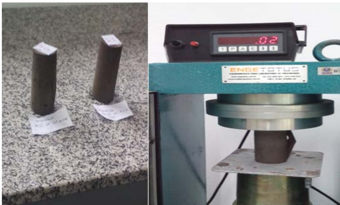
Figura 6: Retirada dos corpos de prova de 14 dias de 5% e 10% de pó de MDF da cura e realização do teste de resistência a compressão.
