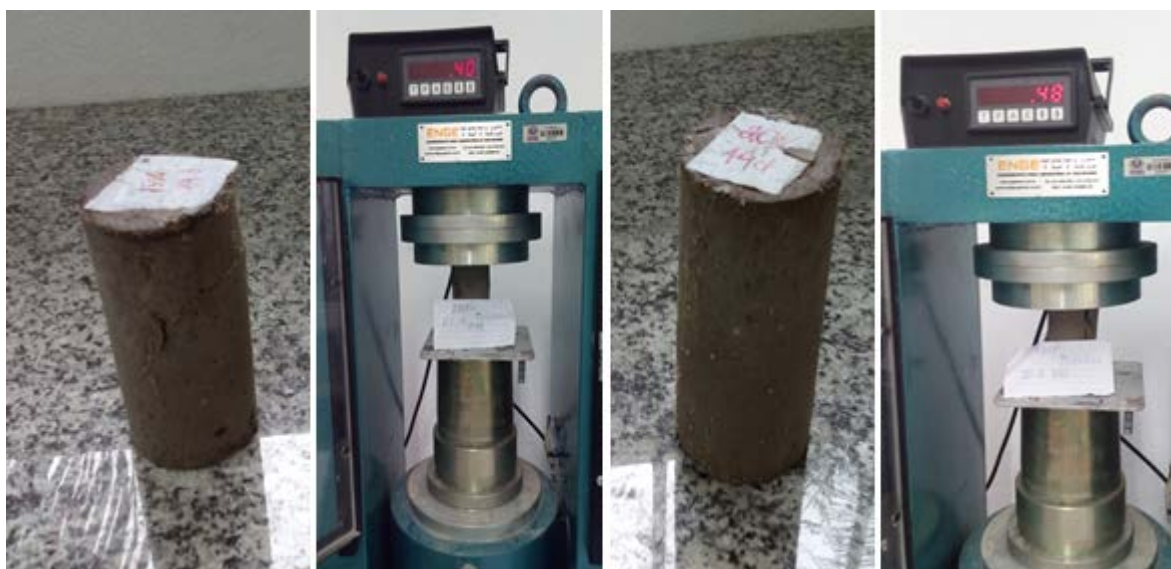
Figura 6: Retirada dos corpos de prova de 14 dias de 15% e 20% de pó de MDF da cura e realização do teste de resistência a compressão.
