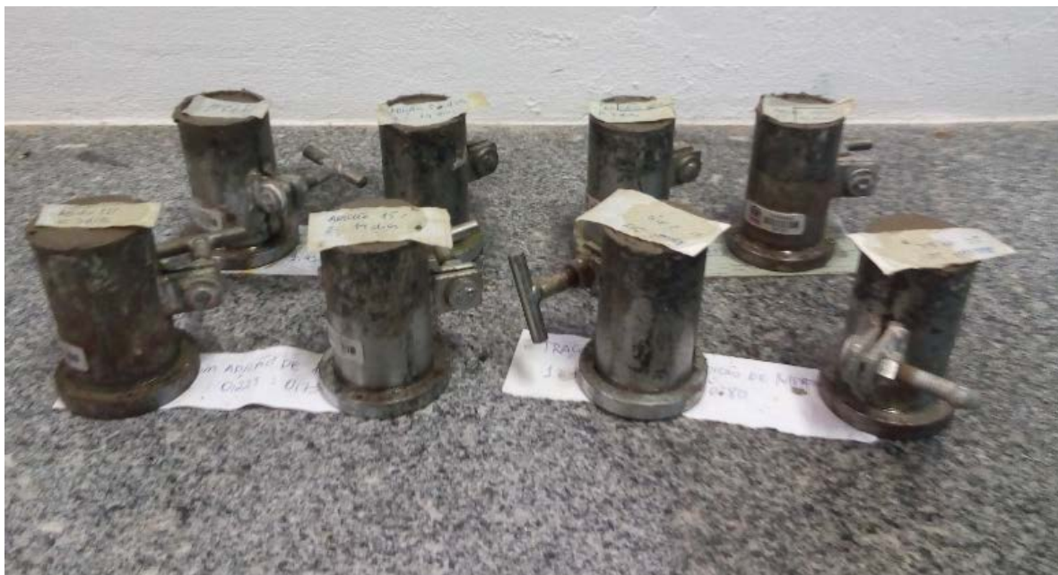
Figura 3: Confecção dos corpos de provas cilíndricos.
