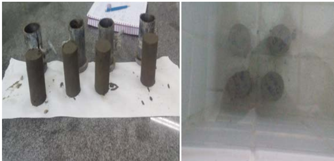
Figura 4: Desmoldagem dos corpos de prova e sua colocação em cura.
