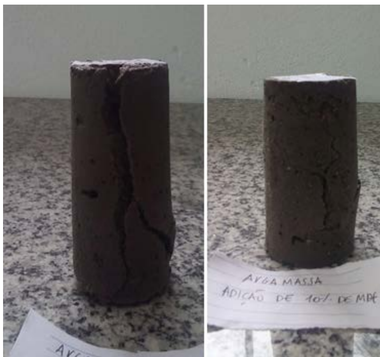
Figura 5: Retirada dos corpos de prova de 7 dias de 5% e 10% de pó de MDF da cura .
