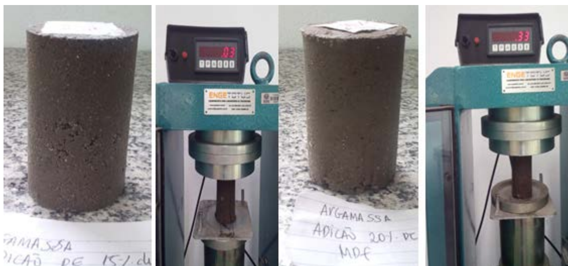
Figura 5: Retirada dos corpos de prova de 7 dias de 15% e 20% de pó de MDF da cura e realização do teste de resistência a compressão.
