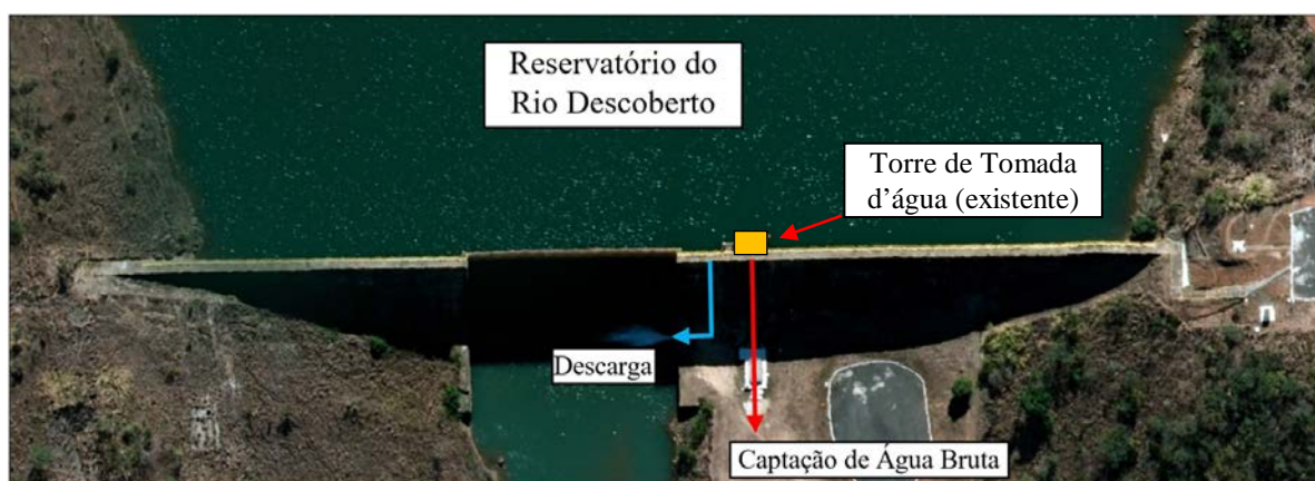
Figura 6 – Visão da Barragem do Rio Descoberto, com destaque para a posição das tubulações de descarga e de captação.
