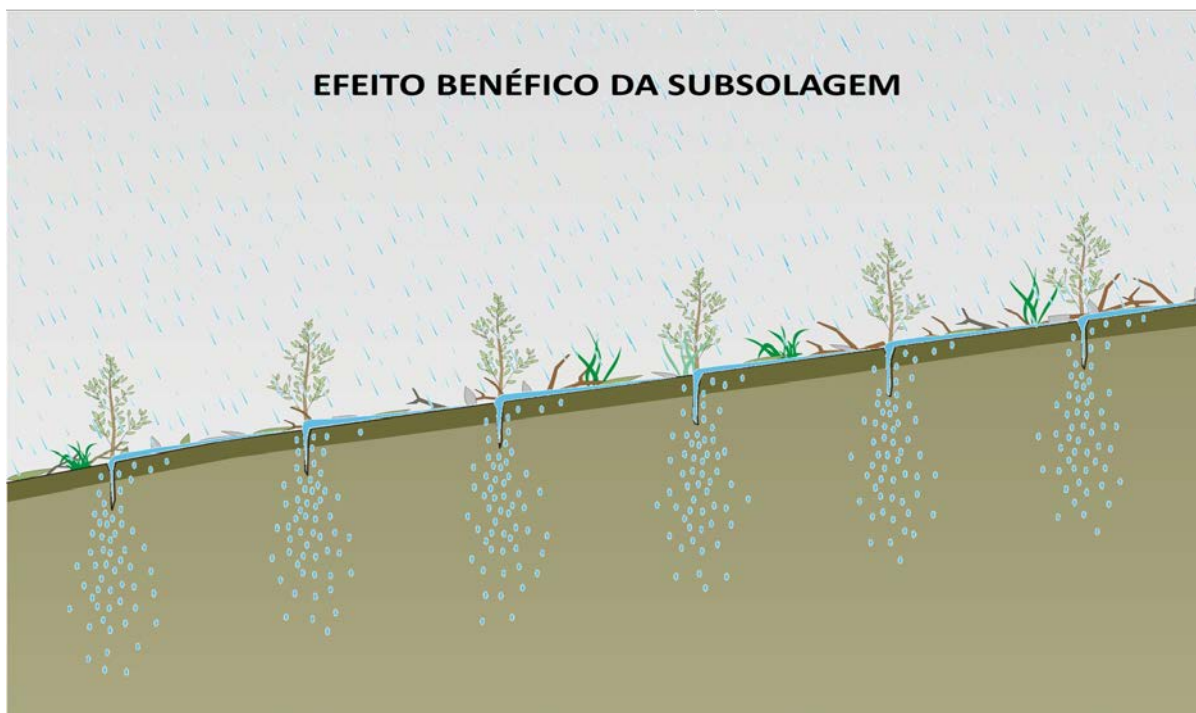
Figura 4: Comportamento do escoamento em área subsolada durante evento de chuva.
