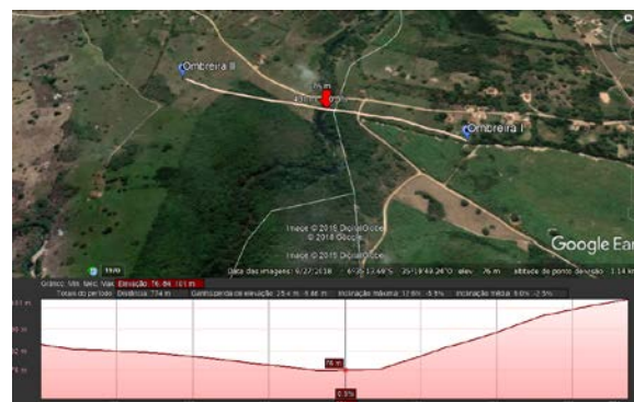
Figura 2-Perfil de elevação do eixo da barragem
