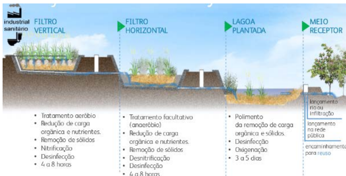
Figura 16: Integração e funcionamento das lagoas de tratamento. Fonte: (PHYTORESTORE (B)) Disponível em: < http://www.pollutec-brasil.com/_novadocuments/231307?v=635954867236630000 >
