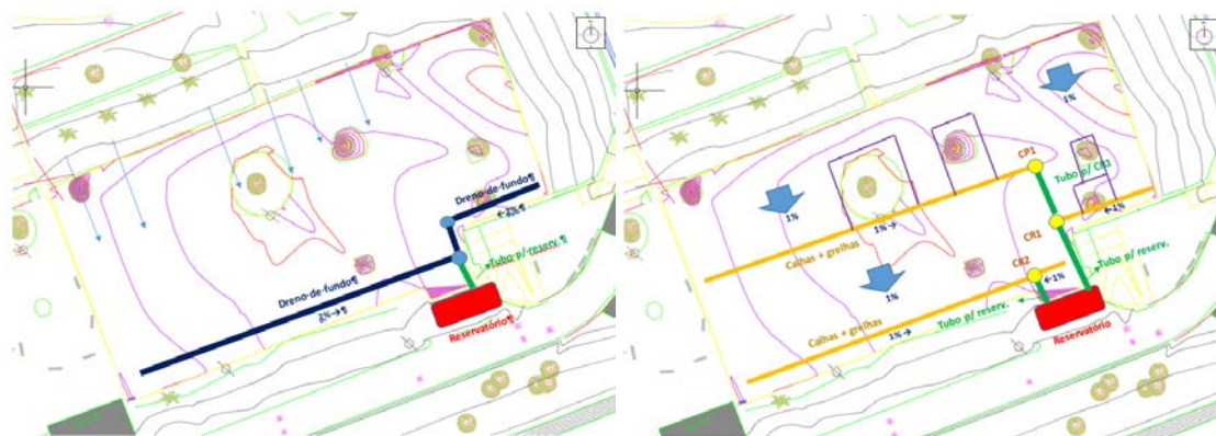
Figura 3: Representação da drenagem subsuperficial, com indicação do reservatório, drenos de fundo e inclinações, e drenagem superficial com indicação do reservatório, calhas, caixas e tubos.
