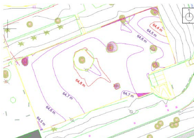
Figura 2: Detalhe do modelo digital do terreno, representando curvas mestras e secundárias do estacionamento.
