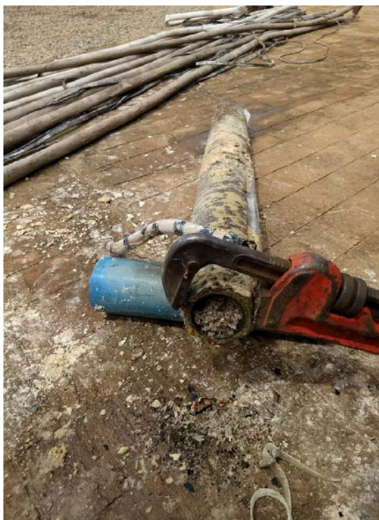
Figura 02 – Equipamento CMBCS removido do poço 01
