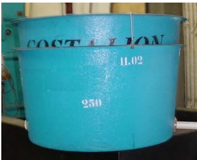
Foto 1 – Protótipo do Reservatório de Águas Pluviais Auto Limpante montado no laboratório da FATEC – SP – out/2003
