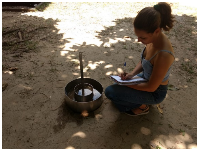
Figura 4: Instalação dos anéis no solo.
