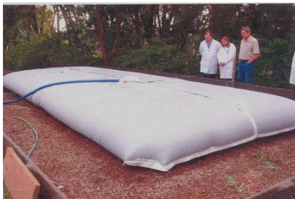
Figura 10 - Teste em escala real realizado na ETA Passaúna
