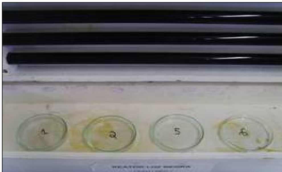
Figura 3. Fonte de irradiação (Reator de luz negra)
