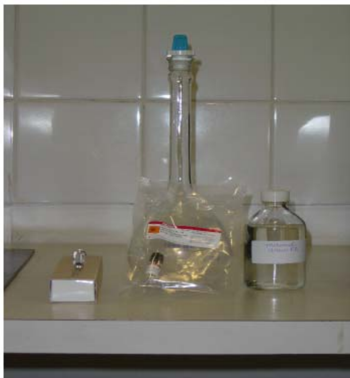
Figura 1 - Preparação da solução estoque através da diluição de padrão contendo 500µg de MYC-LR (FERNANDES, 2008)
