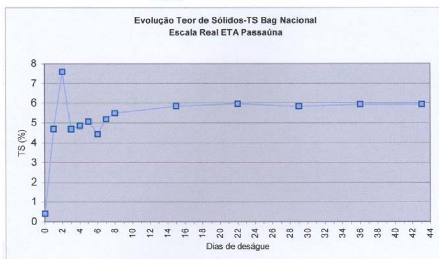
Figura 12 Evolução do teor de sólidos no bag em escala real na ETA Passaúna
