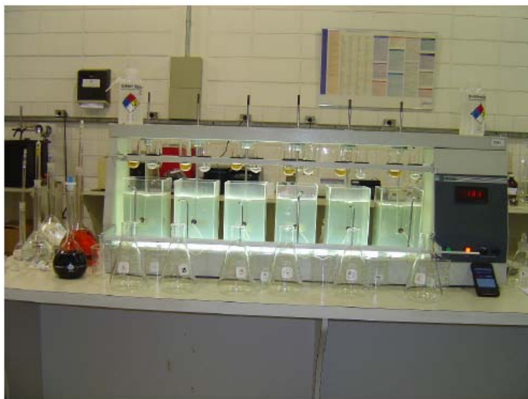
Figura 2 - Execução dos ensaios de bancada visando a otimização do tratamento convencional na remoção de MYC-LR (FERNANDES, 2008)
