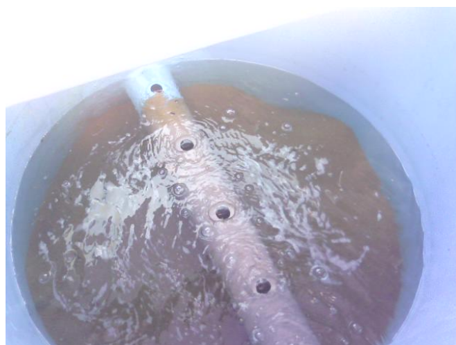
Figura 6 : Vista superior a unidade filtração descendente, após 72 horas de operação
