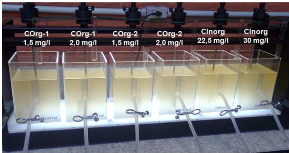
Figura 1: Simulação do processo de coagulação-floculação-sedimentação – Início da Fase de Sedimentação. Turbidez de 67 UNT. Coagulantes orgânicos naturais (Corg 1 e Corg 2) e Coagulante inorgânico (Cinorg).
