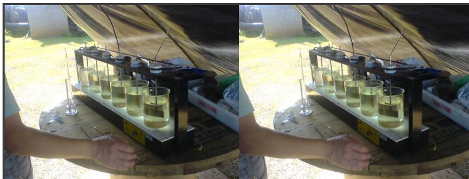
Figura 1: Imagem da análise qualitativa nos ensaios de bancada com Jar Test.
