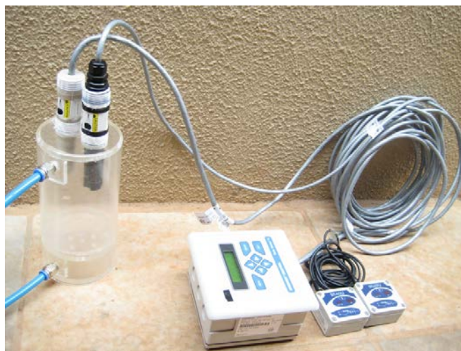
Figura 1. Monitoramento por sondas com analisador e armazenamento de dados.
