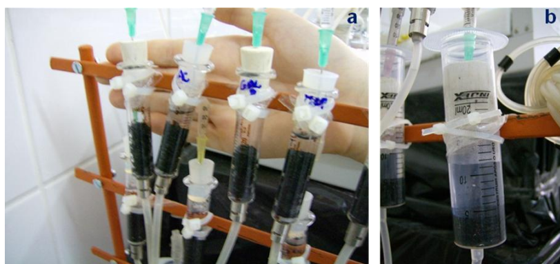
Figura 1. Filtros de carvão confeccionados para os ensaios de remoção de fármacos (a), com detalhamento de sua estrutura (b).
