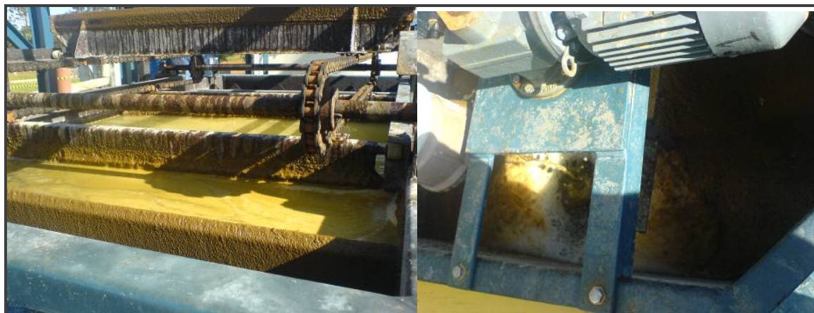
Figura 6: Sistema de desidratação de lodo da unidade Piloto e vista o superior do flotor.
