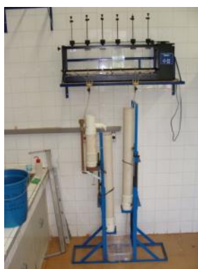
Figura 1 Sistema piloto para ensaios de tratamento de água.
