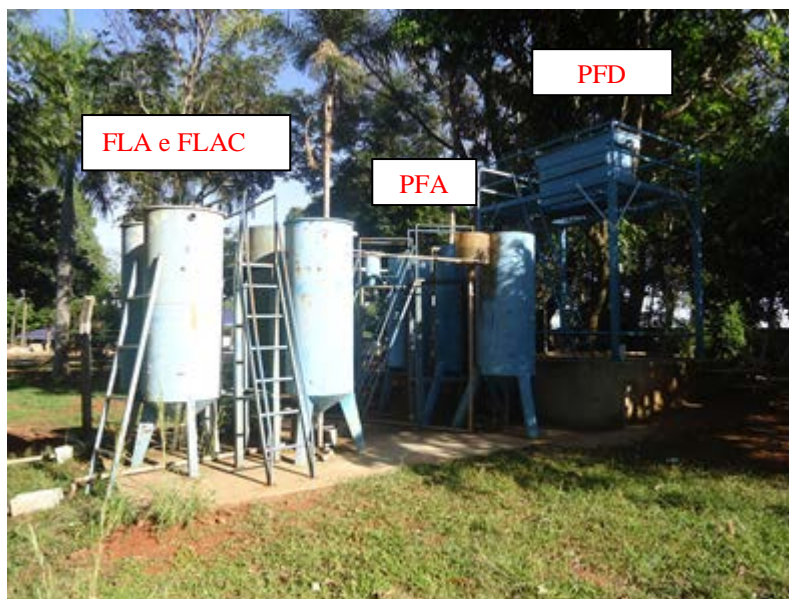
Figura 02- Detalhe da instalação piloto de Filtração em Múltiplas Etapas.
