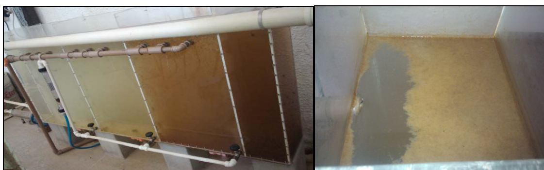
Figura 03 - Vista geral (à esquerda) do ensaio de FFAD com taxa de recirculação a 10% e verificação de arraste de flocos na câmara coletora de água clarificada (à direita).
