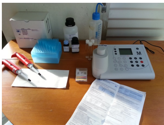
Figura 2: Espectrofotômetro para análise de alumínio
