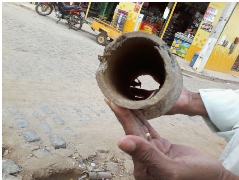
Figura 1: estado de conservação da rede de material de amianto.
