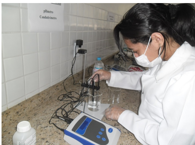
Figura 1: Análise da Condutividade Elétrica no laboratório.
