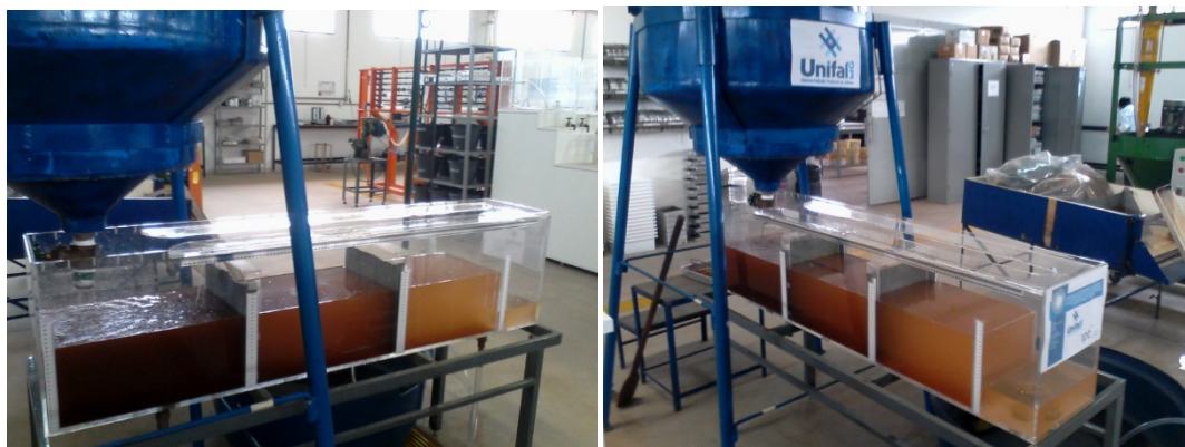
Figuras 3 e 4: Fotos do equipamento em teste. Notar a aparente redução de turbidez.
