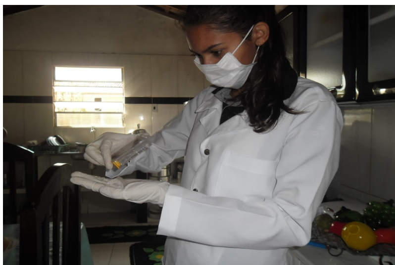
Figura 2: Análise do Cloro Residual Livre In Loco . Fonte: Acervo fotográfico do projeto (2014)
