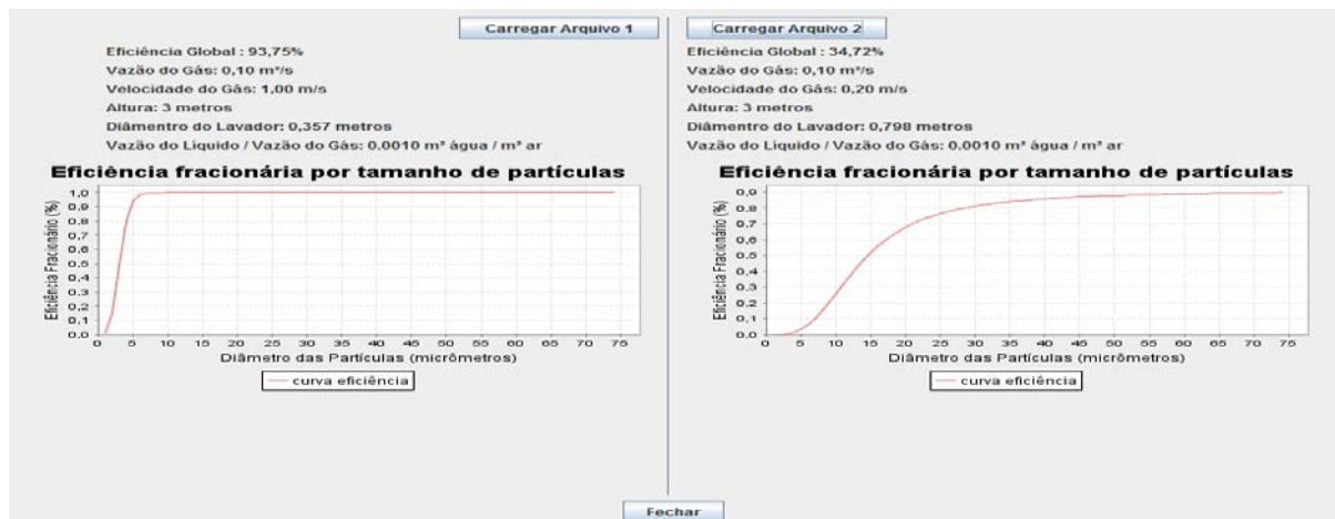
Figura 5: Comparação entre curvas de eficiência fracionária, valores de eficiência total, condições operacionais e dimensões do equipamento.
