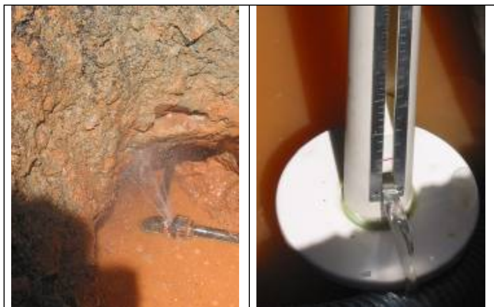
Figura 8 – Aplicação do dispositivo de medição em um vazamento em cotovelo adaptador de plástico de um ramal predial.
