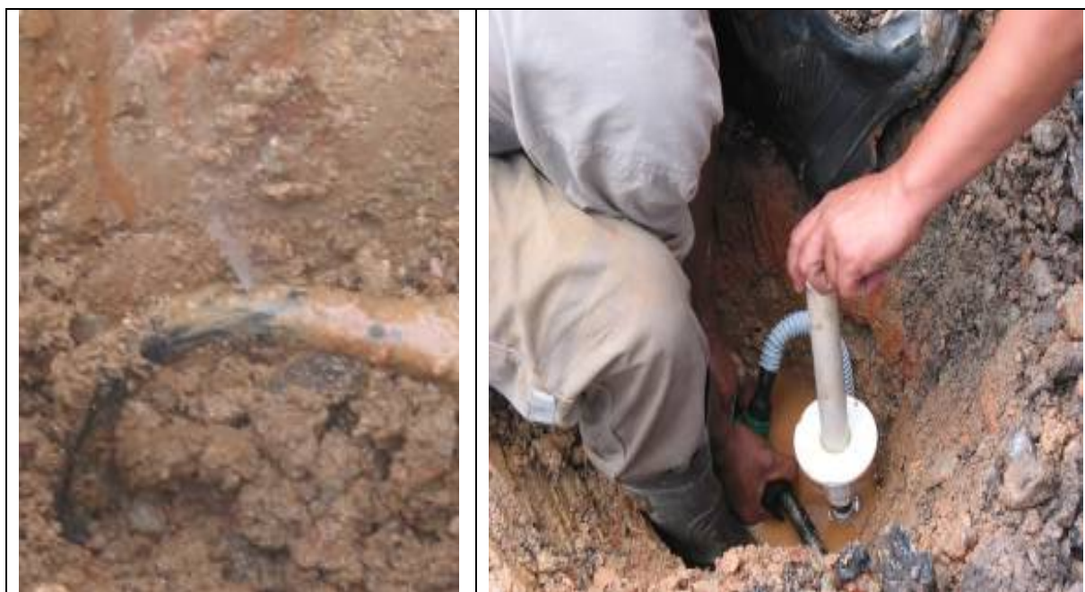
Figura 9 – Aplicação do dispositivo de medição em um vazamento em tubo PEAD de um ramal predial.
