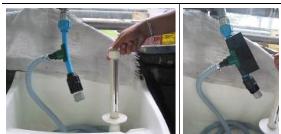
Figura 7 – Bocais de encaixe desenvolvidos para os dispositivos de medição de vazão
