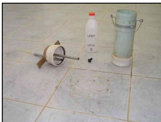
Figura 2 – Fotografia do amostrador de manta de lodos.
