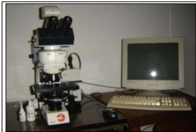
Figura 3 – Sistema de aquisição de imagens para realização de microscopia das morfologias presentes no lodo anaeróbio do reator UASB.
