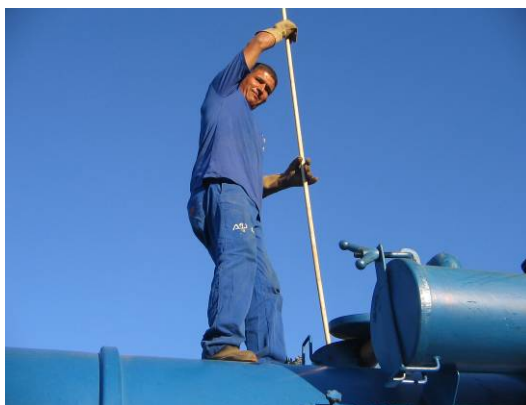
Figura 4 - Procedimento de medida de nível de material no caminhão.
