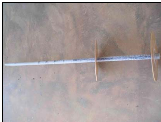
Figura 5 – Medidor de espuma concebido e utilizado no controle operacional de reatores UASB.
