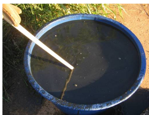
Figura 3 - Homogeneização do lodo no tanque
