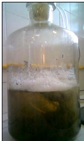
Figura 1: Reator operado na pesquisa, em regime de batelada, com inóculo de Aspergillus niger AN400.
