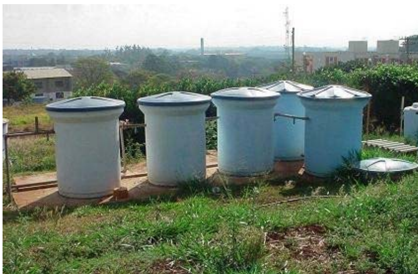
Figura 1: Reator anaeróbio compartimentado.
