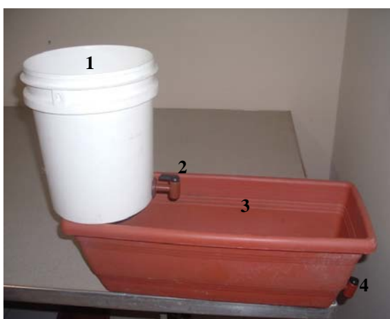
Figura 05 - Descrição ilustrada da montagem de um sistema piloto de LCFSH. 1. Recipiente de armazenamento da vinhaça, 2. Torneira de alimentação do sistema. 3. Leito para crescimento das macrófitas, 4. Torneira de Coleta.
