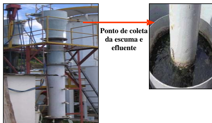
Figura 1: Vista do reator UASB e do decantador (ampliado, à direita).
