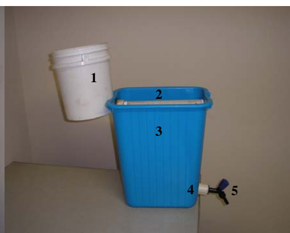
Figura 06 - Descrição ilustrada de um sistema piloto de LCFSV. 1. Recipiente de armazenamento da vinhaça, 2. Tubo de distribuição, 3. Leito para o crescimento das macrófitas, 4. Tubo de drenagem; 5. Torneira de Coleta.
