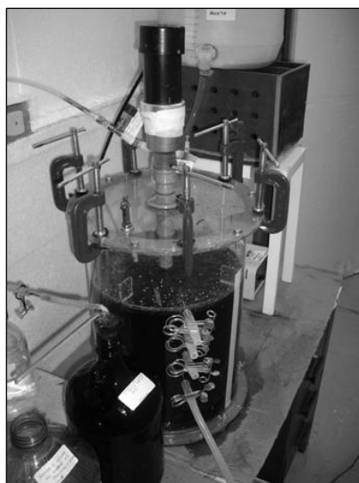
Figura 1: Foto do reator anaeróbio operando em bateladas sequenciais.
