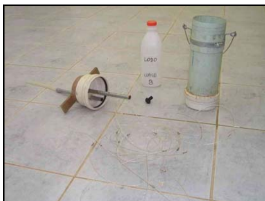
Figura 3 – Amostrador de lodos construído e utilizado no controle operacional de reatores UASB.
