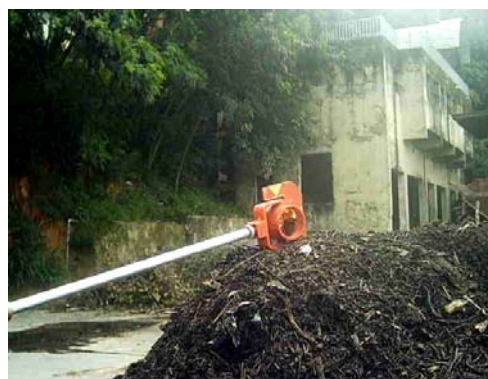
Figura 4 - Colocação do prisma sobre a leira para realização da leitura
