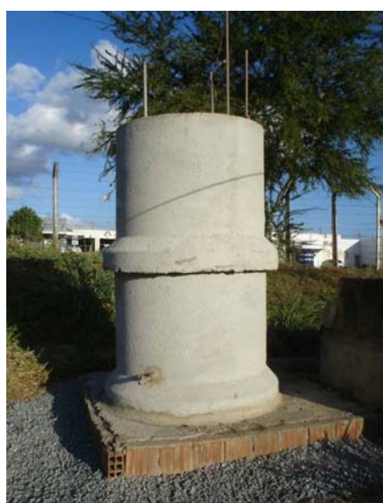
Figura 1: Célula Experimental e Desenho Esquemático (Lisímetro).
