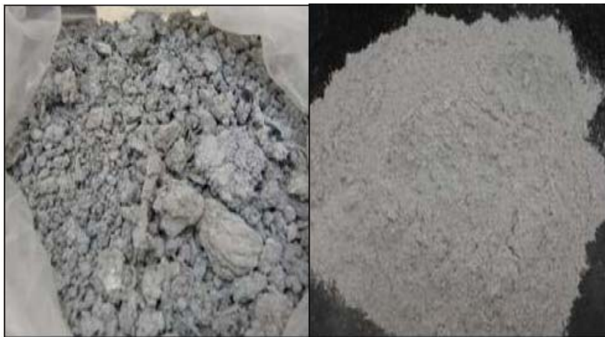
Figura 1: Resíduo antes e após moagem e peneiramento
