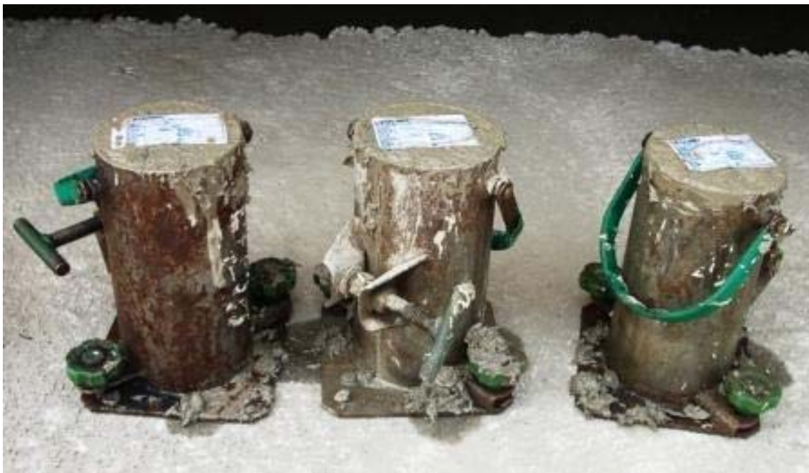
Figura 3: Corpos-de-prova com dimensões de 100 mm de diâmetro e 200 mm de altura
