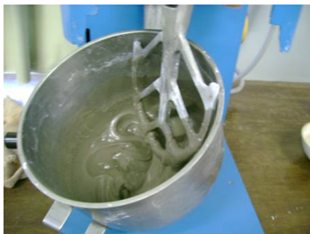
Figura 3: Misturador de argamassa.
