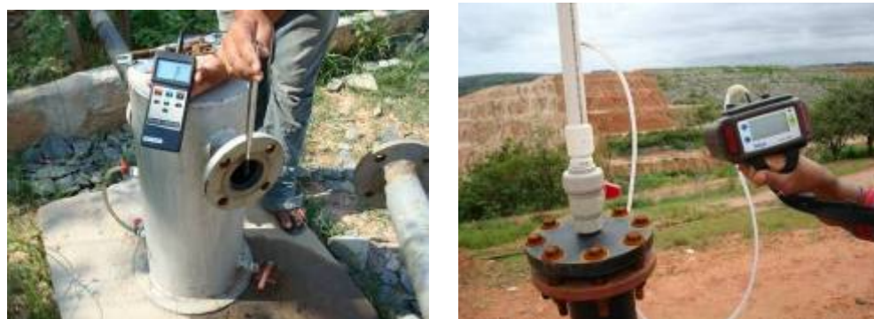
Figura 5. Medição da velocidade na tubulação de coleta do biogás e da concentração no dreno.
