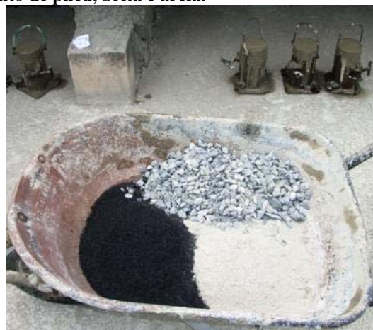
Figura 2: agregados de a) farelo de pneu (esquerda) b) farelo de pneu, brita e areia (direita)
