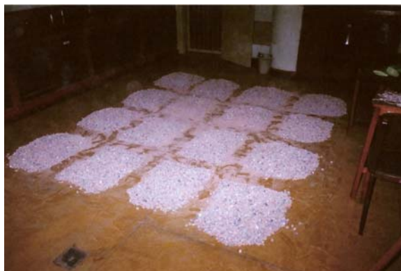
Figura 2: Redução do resíduo sólido da construção civil por quarteamento.
