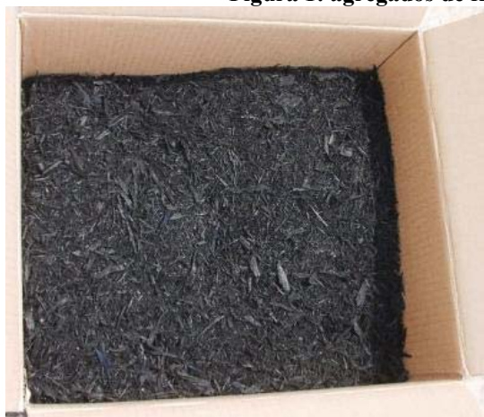
Figura 2: agregados de a) farelo de pneu (esquerda) b) farelo de pneu, brita e areia (direita)
