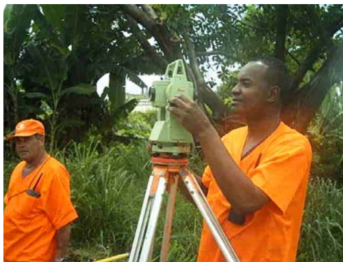
Figura 3 - Leitura topo da leira por meio de estação total
