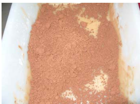
Figura 5: massa de solo-cimento com adição de barbante. Fonte: própria, 2008.
