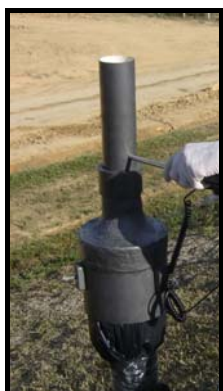
Figura 2: Bocal com curva normalizada para medição de velocidade com Termo-Anemômetro
