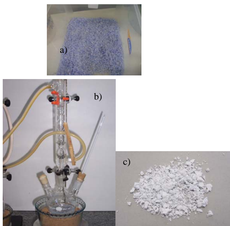
Figura 1 – Etapas da preparação do material: a) Moagem; b) Dissolução e c) Precipitação.
