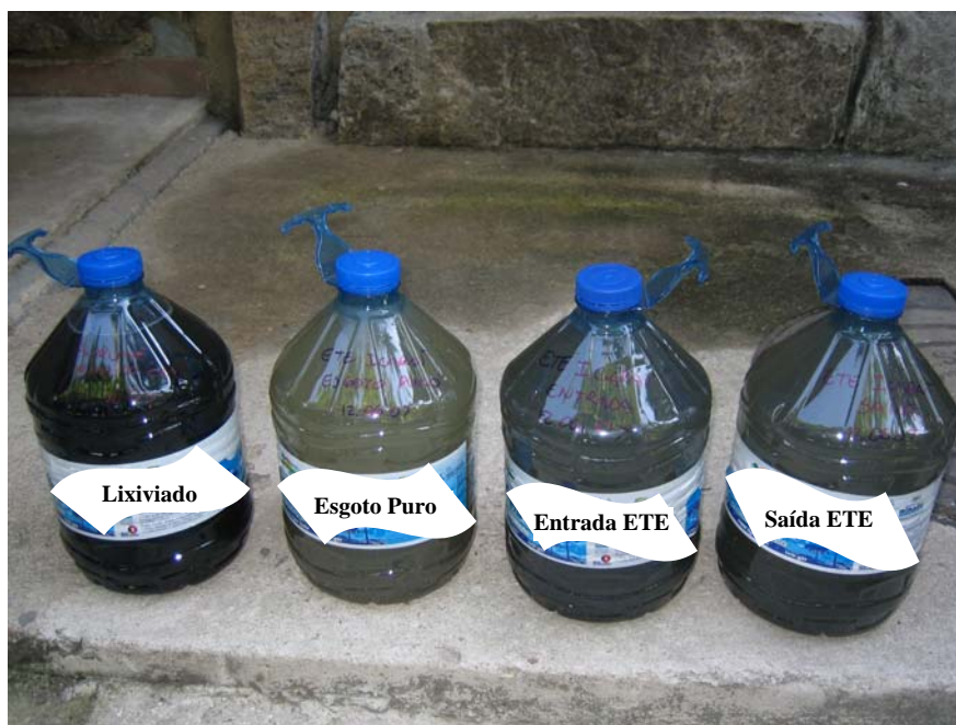
Figura 2. Amostras coletadas para ensaios de caracterização e ensaios ecotoxicológicos.
