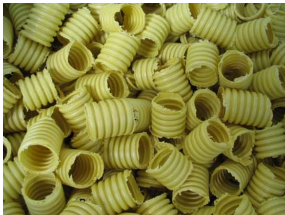
Figura 2: Anéis de Raschig corrugados usados como material de recheio.
