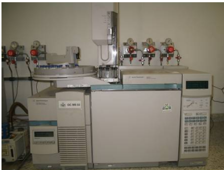
Figura 04: Equipamento utilizado nas análises de Compostos Orgânicos Voláteis
