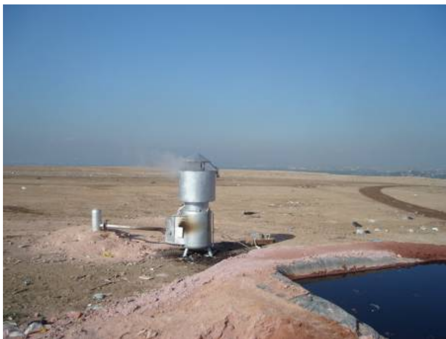
Figura 01: Evaporador Unitário em operação próximo à lagoa de acumulação de lixiviado
