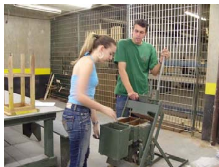
Figura 6: compactação mecânica dos tijolos. Fonte: própria, 2008.
