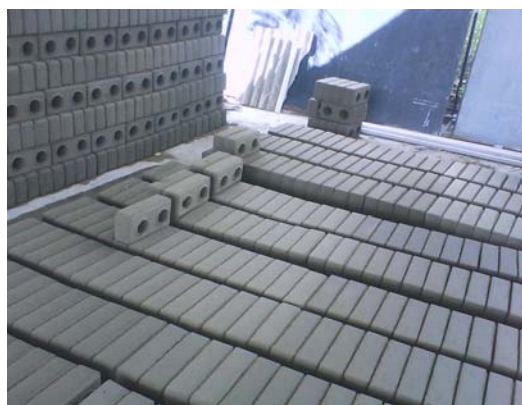
Figura 2 - Tijolos de solo-cimento incorporados com resíduo granítico. Fonte: PRÓPRIA, 2008.
