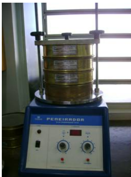
Figura 1: Peneirador Mecanizado.
