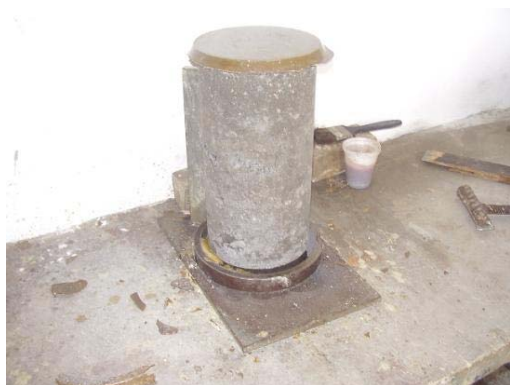
Figura 5: Capeamento dos corpos-de-prova.
