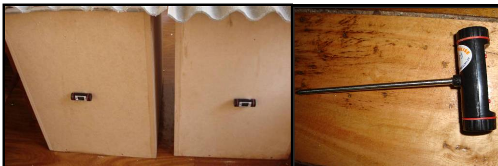
Figura 1: Células teste com medidores de temperatura digitais instalados (esquerda) e medidor temperatura digital (direita)
