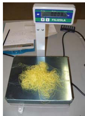
Figura 4: pesagem das fibras utilizadas nos ensaios preliminares.
