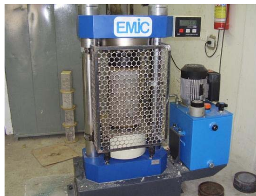
Figura 6: Ruptura dos corpos-de-prova.
