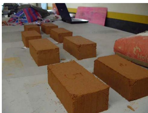
Figura 7: secagem dos tijolos. Fonte: própria, 2008.
