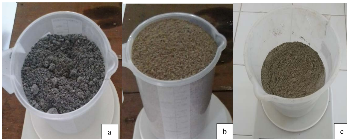
Figura 1: a- resíduo de couro cromado; b- areia comum; c- cimento Portland.
