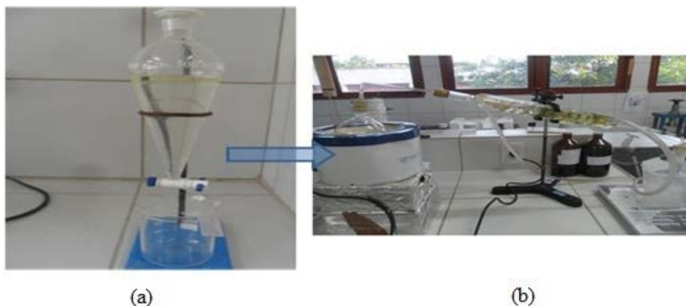
Figura 3: Funil de separação (a) e sistema manta aquecedora – destilador (b) para extração de óleos e graxas.
