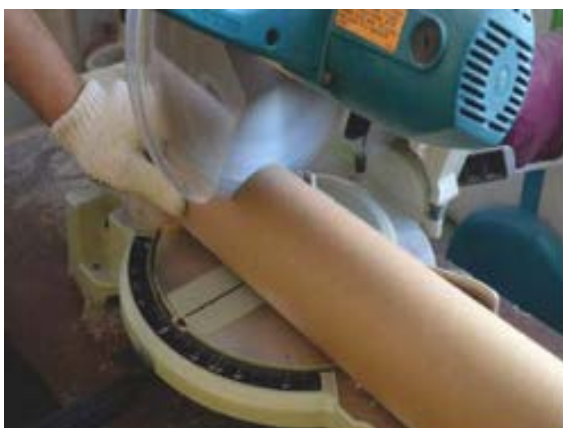
Figura I – Corte do tubo de papelão
