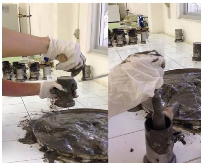
Figura 2: Confeção dos corpos de prova
