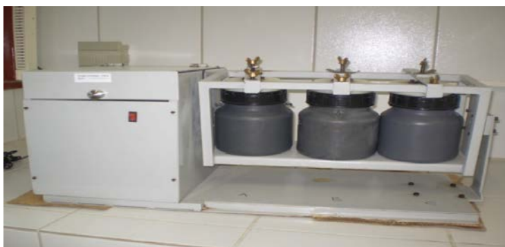
Figura 2: Aparelho Rotativo de Frascos para Lixiviação.
