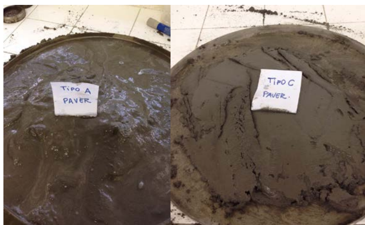
Figura 1: Tipo (A) com o Fator A/C 3; Tipo (C) com o Fator A/C 2
