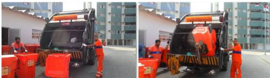
Figura 8 - Caminhão compactador basculando contêiner com resíduos sólidos
