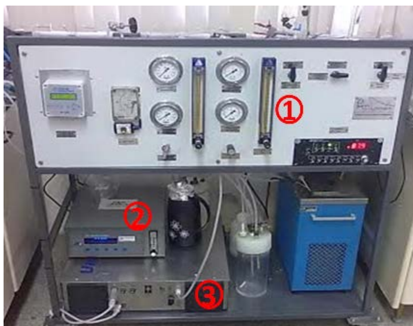
Figura 2: Gerador de Ozônio composto de medidores de vazão (1), analisador de ozônio (2) e gerador de ozônio (3).
