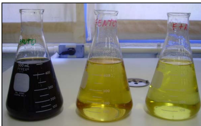
Figura 9: A direita lixiviado bruto; centro lixiviado após processo de coagulação; Esquerda lixiviado após processo fenton. Fonte: Os autores (2014).
