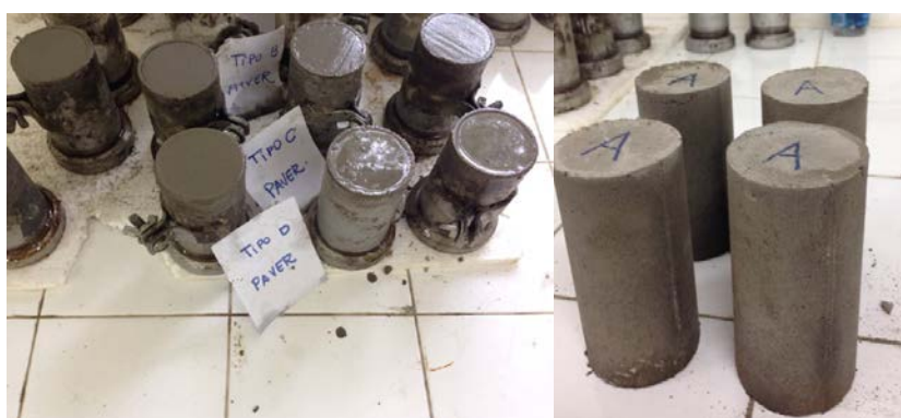
Figura 3: Corpos de prova moldados e desmoldados
