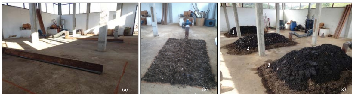
Figura 2: Montagem dos sistemas de leiras estáticas aeradas. (a) Inserção de dutos de distribuição de ar sob as leiras; (b) disposição de um meio absorvente do líquido lixiviado da leira; (c) conformação final das unidades experimentais 1, 2 e 3.
