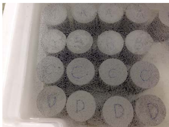
Figura 4: Corpos de prova em cura
