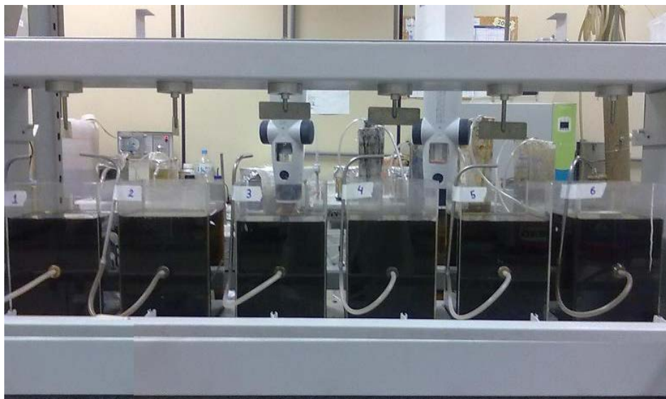
Figura 1: Aparelhagem de “Jar-Test” utilizada nos experimentos de coagulação/floculação
