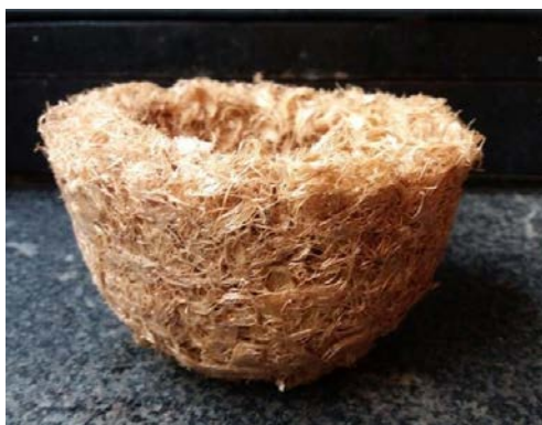
Figura 03: Vaso fabricado a partir de fibras do caroço do açaí.
