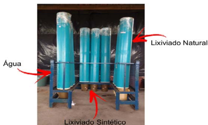
Figura 2 – Experimento: colunas com tubos de PVC contendo solo compactado, submetidas a diferentes líquidos
