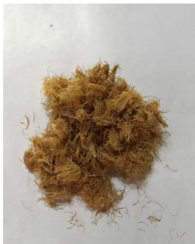
Figura 02: Fibras retiradas do caroço do açaí.
