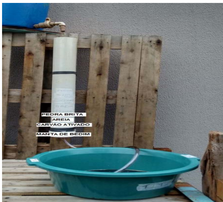
Figura 2: Filtro de areia, pedra brita e carvão ativado.
