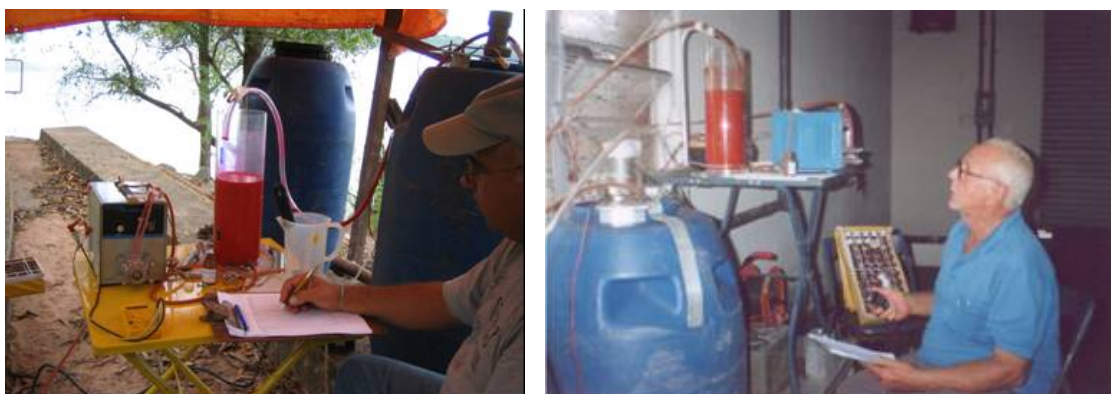
Figura 2: Injeção contínua de traçador fluorescente realizada na entrada de emissários submarinos.
