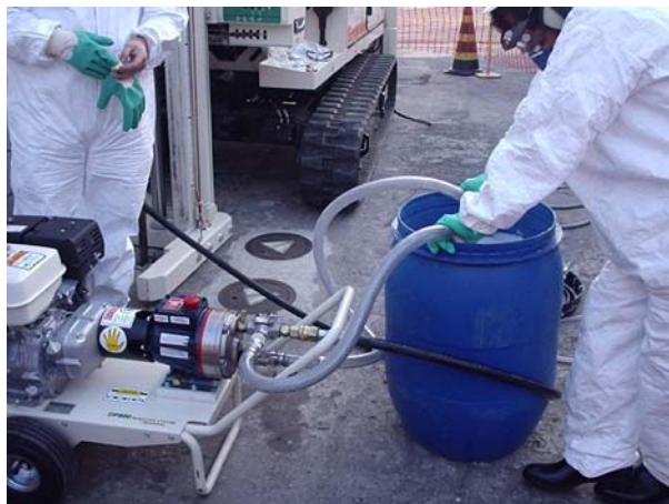
Foto 1: Aplicação do acelerador de remediação pelo método de injeção com pressão ( direct-push )
