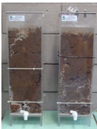
Figura 02: Simulação dos ensaios nas colunas de acrílico.
