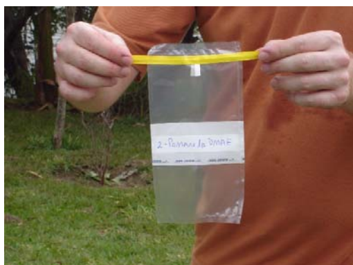
Figura 1: Saquinho estéril para acondicionamento de amostra para análise microbiológica
