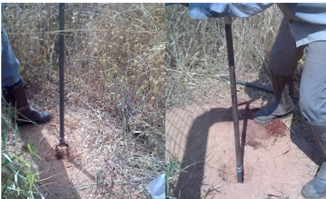
Figura 4: Escavação de poços na cobertura e retirada de amostras deformadas com auxílio de trados manuais.
