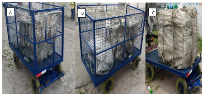
Figura 11: Veículo de tração humana desmontável desenvolvido por Sousa (2018) para coleta e transporte de resíduos sólidos recicláveis secos: A) Visão frontal; B) Visão lateral; C) Estrutura desmontável transformada em plataforma.
