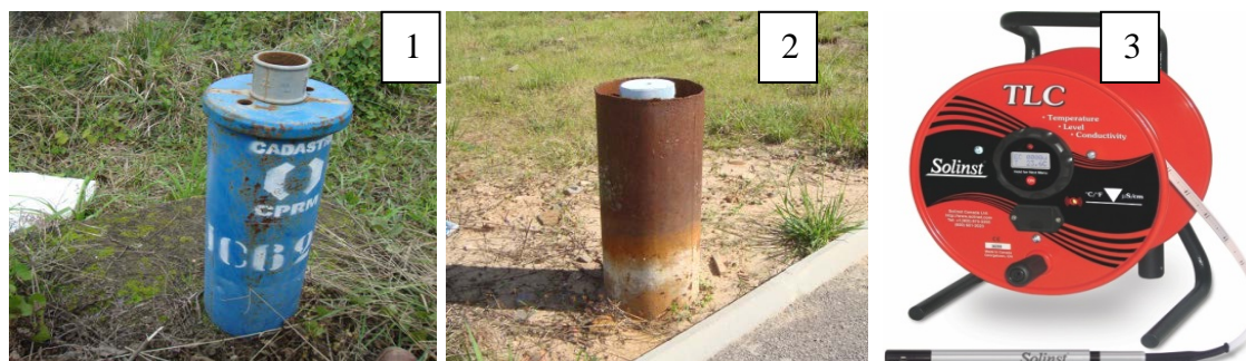
Figura 2: 1 Poço Planetário, 2 Poço da Biblioteca e 3 aparelho freatímetro sonoro TLC Solinst usado nas medições dos parâmetros na coluna de água dos poços.
