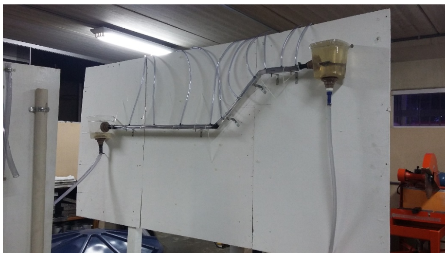
Figura 6: Piezômetros instalados no sistema.
