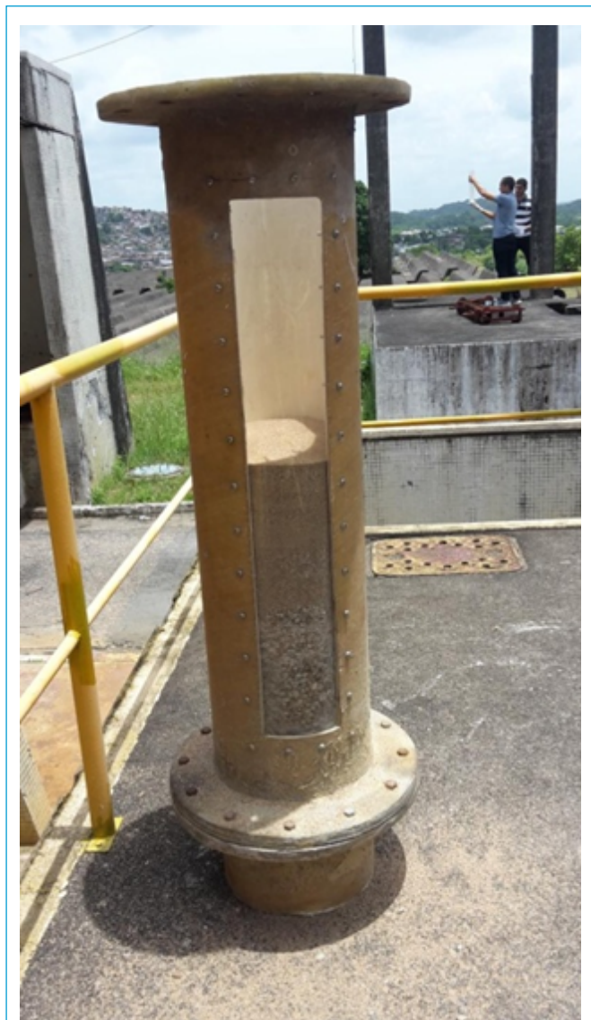
Figura 1 - Clarificador piloto carregado com o leito de pedregulhos.
