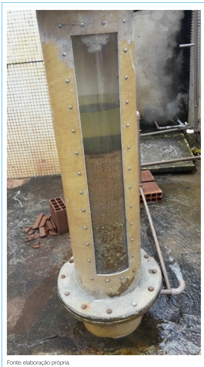
Figura 2 - Descarga no clarificador piloto.
